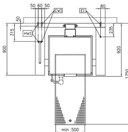
Brasiera elettrica basculante, con fondo in compound, 90 lt. (h), carico automatico acqua calda/fredda con rubinetto, doccia, kit di chiusura posteriore. L'azienda si riserva il diritto di apportare modifiche ai prodotti senza preavviso
